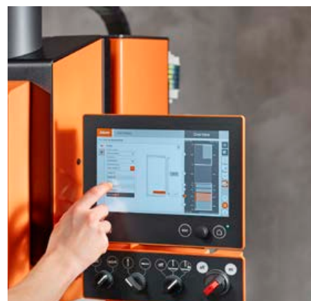
Unesite podatke o korpusu i dimenzije fronte, odaberite okov, a EASYSTICK će automatski odrediti pozicije za bušenje.
