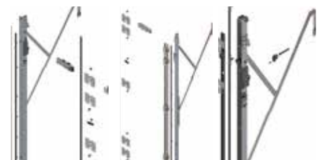
Dodatni nosač spojnica omogućava realizaciju fronti visine do 2980 milimetara.
