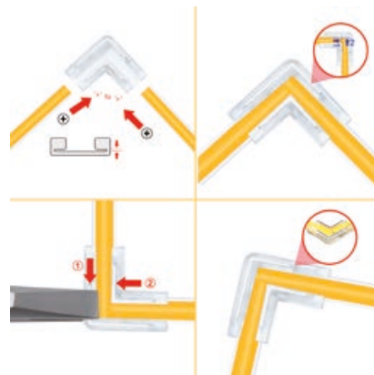
Obrada kutnog veznika
