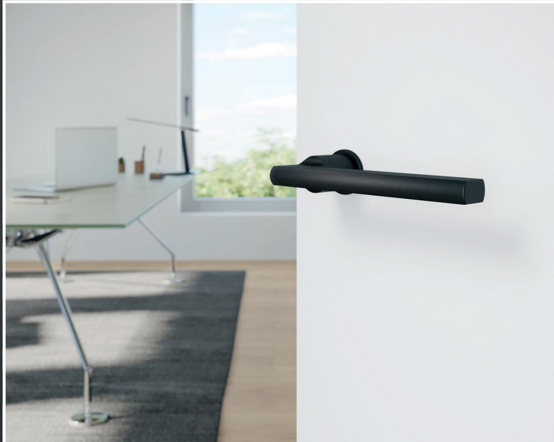
ponavljanja, FSB dokazuje svoj kvalitet. Montaža novih FSB plug-in kvaka je olakšana. Prije svega, potrebno je pripomiti rupe za rozete na vratima, koje su prikladne za promjere od 26 ili 27 mm. Stezne rozete su umetnute u izbušene rupe na vratima sa obje strane. Adapteri se postavljaju na zatik koji je postavljen u bravu i učvršćen vijcima bez proboga. Konačno, postavljaju se rozete i kvake se mogu pričvrstiti.
